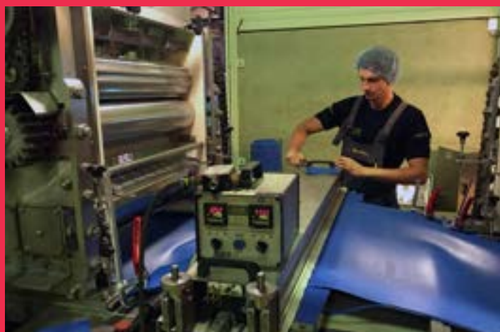
Dag en nacht monteren en lassen van kunststof transportbanden.
