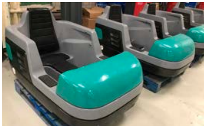
Maken en herstellen d.m.v. glasvezelversterkte polyester en coaten met poly-urea van pretpark-attracties.
