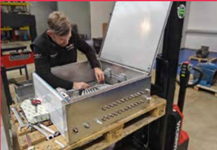
Herstellen, samenstellen en bouwen van perslucht-sturingskasten.
