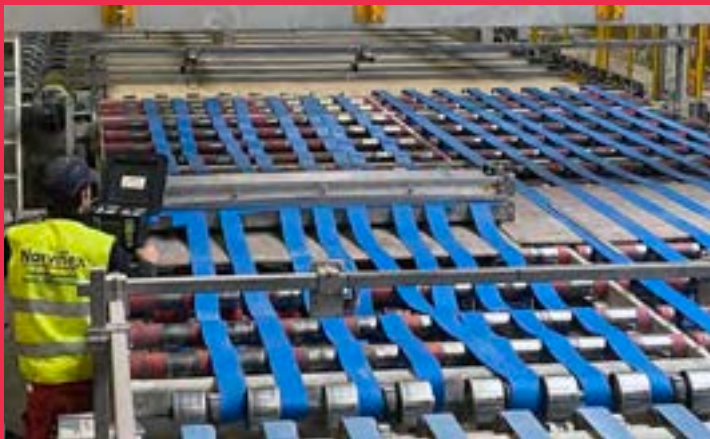
Monteren en eindloos lassen van drijf-, proces- en tandriemen.
