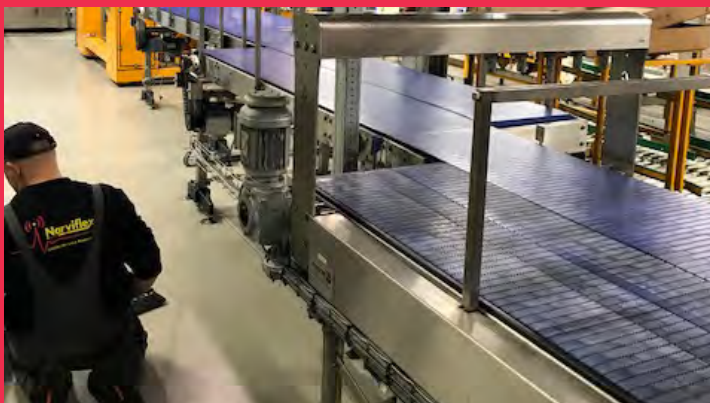
Ombouwen van kettingen-transport naar installatie met schakelbanden.
