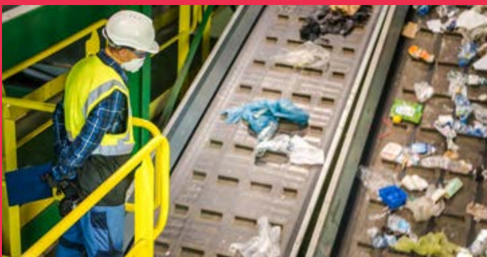
Ombouwen van kettingen-transport naar installatie met schakelbanden.
