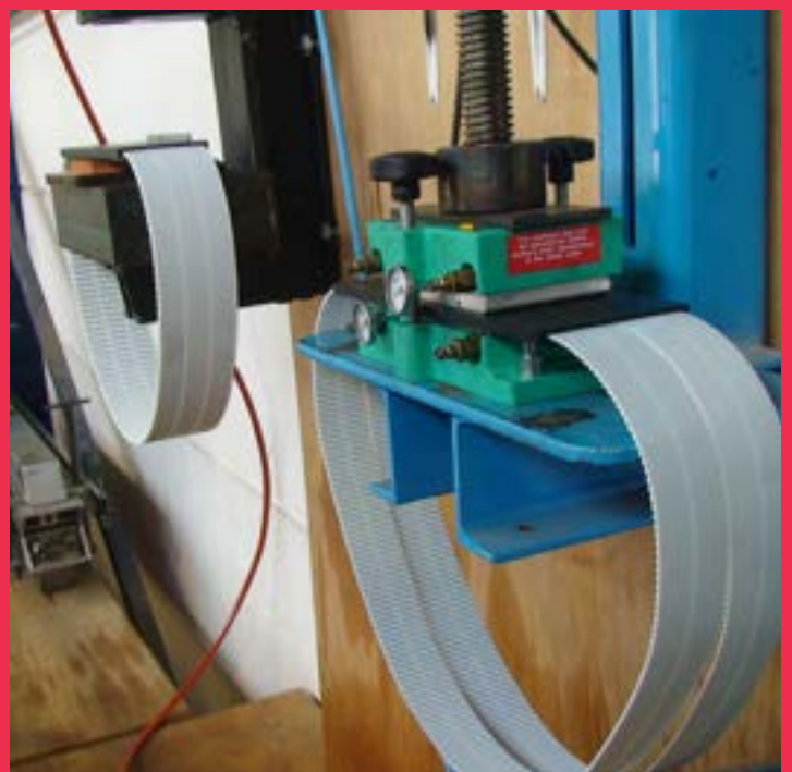
Bij Narviflex stockeren wij het tandriem-materiaal op rol en kunnen deze lassen (ook bij u ter plaatse), bekleden en voorzien van meenemers.
