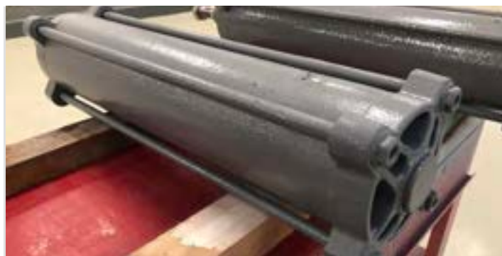
Coating met poly-urea van zware perslucht cylinders om deze bestand te maken tegen moeilijke omstandigheden
