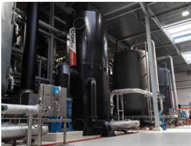
Induss: combinatie van RVS en kunststof leidingwerk
