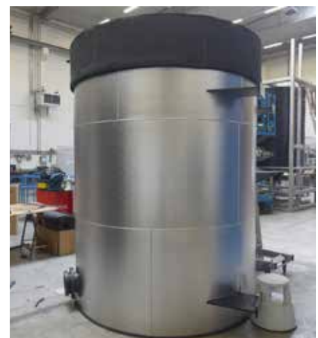
Isolatie van tank
