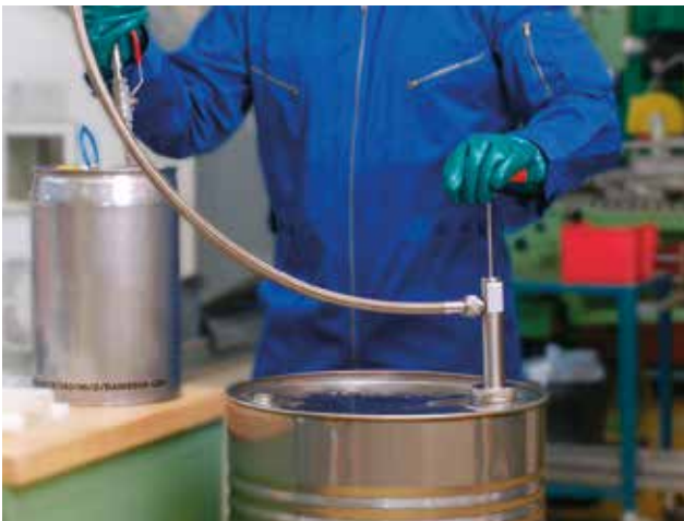
Manuele vatpomp in RVS voor het verpompen van chemicaliën
