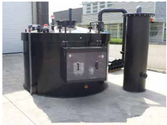
AB InBev: gaswasser voor het neutraliseren / reinigen van schadelijke gassen
